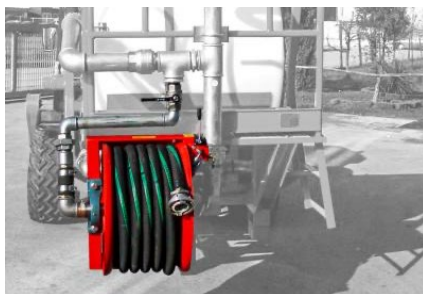
Hydraulische slanghaspel Met 40 meter slang
